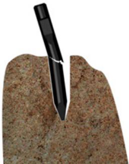
Средняя часть инструмента рыхлителя выдерживает значительно большие нагрузки
