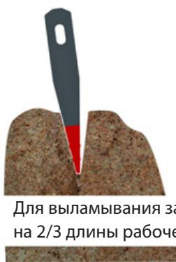
Основная часть инструмента рыхлителя не предназначена для выламывания (закрашена красным)
