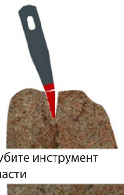
Для выламывания заглубите инструмент на 2/3 длины рабочей части
