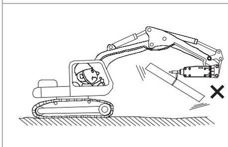
Никогда не используйте гидромолот как грузоподъемное средство. Это может привести к опрокидыванию базовой машины или поломке гидромолота.
