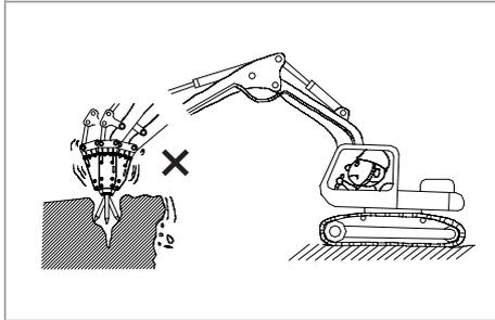
Не используйте инструмент как рычаг. В гидромолоте может быть поврежден инструмент и другие детали молота.
