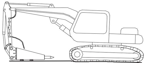
1. Установите гидромолот на горизонтальной поверхности на деревянных брусках.
