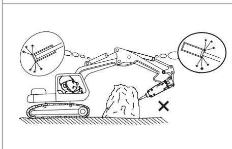
Не используйте гидромолот при полностью выдвинутых (вдвинутых) цилиндрах стрелы и рукояти. Это может привести к повреждению гидромолота или базовой машины. Поддерживайте запас хода цилиндров базовой машины по крайней мере 100 мм.
