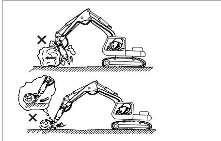
Не используйте гидромолот, чтобы перемещать камни концом инструмента или корпусом гидромолота.
