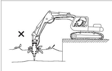
Не используйте гидромолот в воде. Использование гидромолота без специального оснащения может привести к разрушению гидравлических компонентов.
