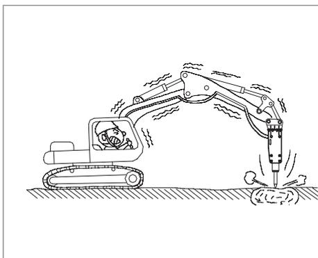
Правильное положение позволит более эффективно использовать разрушающее усилие. В противном случае ударная сила будет направлена на корпус гидромолота, рукоять и стрелу базовой машины, что приведет к повреждению данных механизмов. Работайте гидромолотом только спереди или сзади базовой машины. Не используйте гидромолот с боковых сторон базовой машины. Это может привести к опрокидыванию экскаватора или резким разрушительным колебаниям машины.
