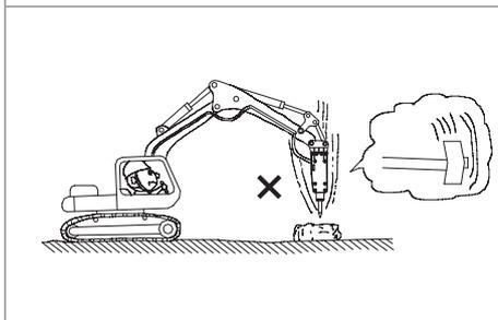
Не используйте гидромолот как кирку. Такое использование может привести к повреждению элементов гидромолота или резким колебаниям механизмов базовой машины.
