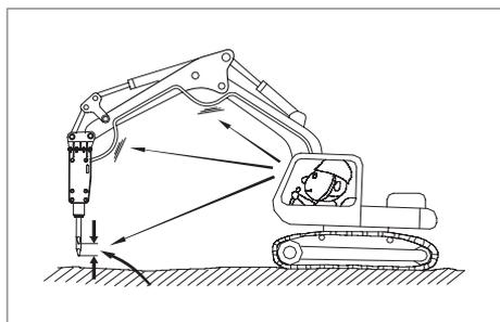
Остановите работу гидромолота, если гидравлические рукава чрезмерно вибрируют. Проверьте давление азота в аккумуляторе и пневмокамере гидромолота.
