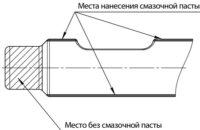
Для смазки рабочего инструмента гидромолота рекомендуется использовать высококачественную консистентную смазку на минеральной основе с дисульфидом молибдена. Например, Impulse Protection M-500. Так же подойдет более высокотемпературный аналог на основе минеральных масел, загущенных комплексным алюминиевым мылом, Delta Marathon DM 3000, либо она же в исполнении картриджей для автосмазки Delta In Rock.
