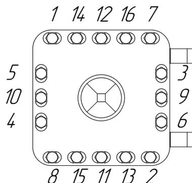
Гайки нижней плиты затягиваются в последовательности, указанной на схеме выше, сначала предварительным моментом, затем в той же последовательности окончательным моментом (см.таблицу моментов затяжки).
