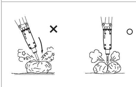
Соблюдайте угол наклона гидромолота. Угол наклона не должен превышать  $\pm 15^\circ$  от перпендикулярного положения к разрушаемой поверхности. В противном случае рабочий инструмент будет проскальзывать во время дробления, и может повредиться боек и заклинить или сломаться сам инструмент.
