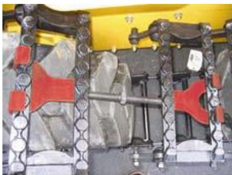
**Шаг 9:** Начинайте стягивать гусеницу путем закручивания гайки ключом-трещоткой, которая идет в установочном комплекте.
