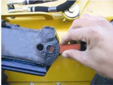
**Шаг 11:** Вставьте крепежные болты в отверстия так, чтобы гайка была с внешней стороны гусеницы.
