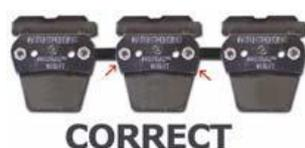
Одна из правильных схем регулировки представлена на этом рисунке. Подушки чередуются – правая часть болты во внешних отверстиях, левая часть один внутренний, один внешний. Это правильно.
