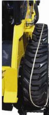
**Шаг 4:** Проедьте чуть-чуть вперед, чтобы задняя часть гусеницы легла на колесо.
