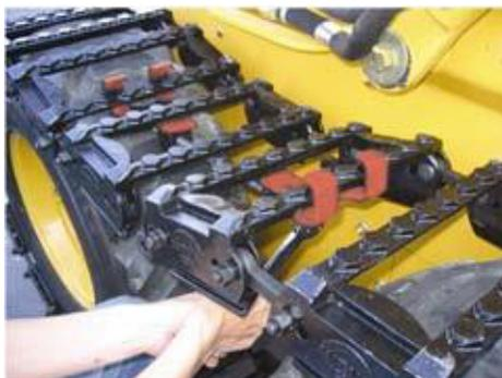
**Шаг 14:** Уберите натяжитель и проехайте погрузчиком чуть-чуть вперед, чтобы можно было затянуть крепежные болты с внутренней стороны гусеницы. Затяните гайки.
