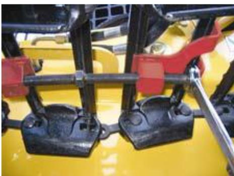
**Шаг 10:** Зафиксируйте крепежную скобу в отверстиях гусеницы с обеих сторон. Отверстия должны полностью совпасть
