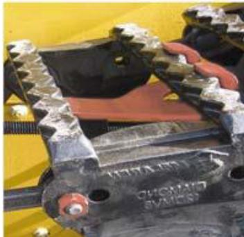
**Шаг 13:** После того, как все гайки крепежа будут затянуты можно убрать натяжитель. Для этого ослабьте немного болт натяжителя.
