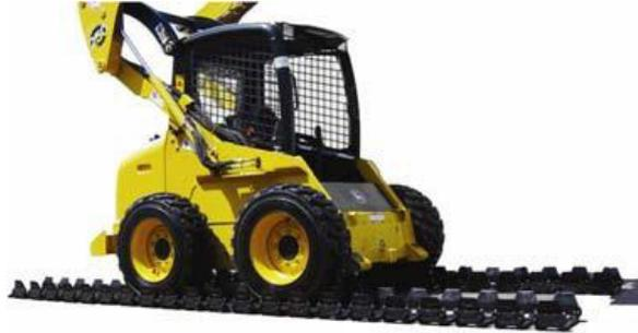
**Шаг 4:** Накиньте заднюю часть гусеницы на заднее колесо минипогрузчика.
