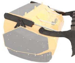
Гидравлическая рама-толкатель обладает рядом преимуществ по сравнению с механической: амортизация ударных нагрузок, увеличенное толкающее усилие за счет гидроцилиндров, управление наклоном рамы из кабины оператора.
