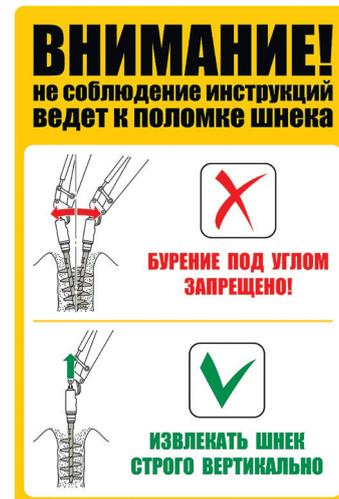
Если, при попытке извлечь буровой инструмент, заполненный грунтом, возникает сильное сопротивление, переключите вращение бура на реверсное и, медленно, поднимайте его из скважины в вертикальном положении.
