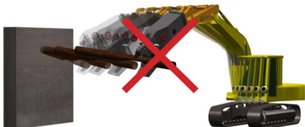
**Не используйте данный инструмент для демонтажа методом ударного разрушения!**
