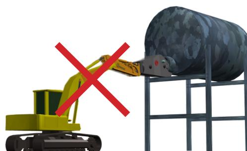
**Предотвращайте чрезмерное усилие на прокалывающем зубе ножниц**
