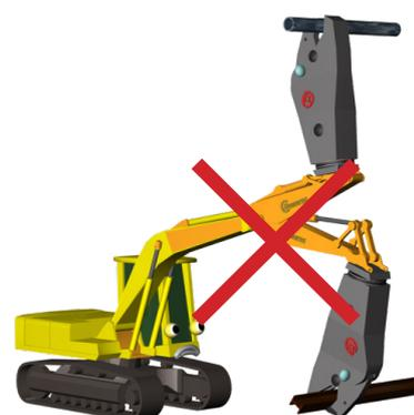
**Не используйте инструмент для демонтажа, когда цилиндр ковша находится в крайнем положении!**
