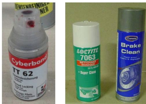
Нанесите на наружную резьбу только каплю геля для насоса Cyberbond TT62 примерно на 2/3 окружности второй резьбы для фитингов диаметром до 20 мм или на всю окружность для фитингов диаметром более 20 мм.
