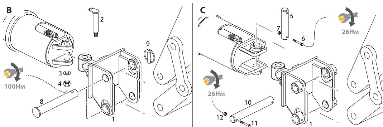
**Существуют два типа пальцев для крепления двухпальцевой подвески к базовой машине:**
