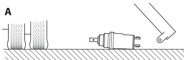
Расположите гидровращатель в горизонтальном положении, так чтобы выходной вал был направлен к базовой машине, как показано на рис. А.
