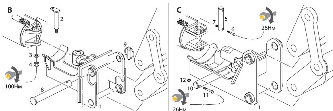
**Существуют два типа пальцев для крепления двухпальцевой подвески к базовой машине:** При использовании шплинта (рис. В), совместите отверстия для пальцев на подвеске и на стреле, полностью вставьте палец (8) и зафиксируйте его шплинтом (9).
