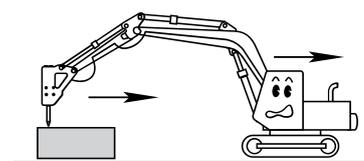
При прижатии молота к объекту работы инструмент отклоняется в сторону, в пределах зазора между его хвостовиком и втулками, его ось не совпадает с осью бойка гидромолота, поэтому при ударе возникает дополнительный изгибающий момент, величина которого увеличивается с увеличением зазора.
