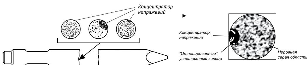
Обычно размер усталостной области указывает на уровень напряжений, приложенных к инструменту, т.е. чем меньше усталостная область, тем выше уровень напряжений, хотя следует учесть, что если зарождение усталостной трещины имело место, то, чтобы заставить ее расти, требуется напряжение меньшего значения.
