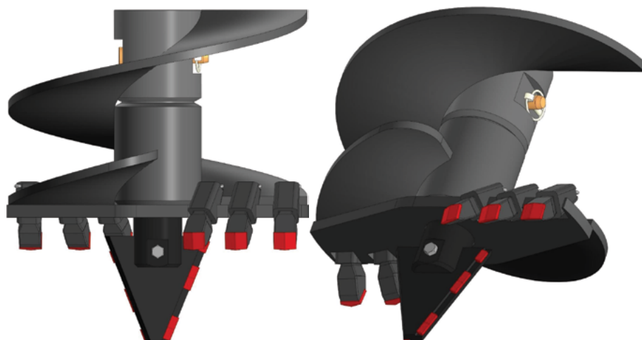
Бур типа БЛА-56 на примере D500 (Забурник 300А, резцы РБМ-35)
