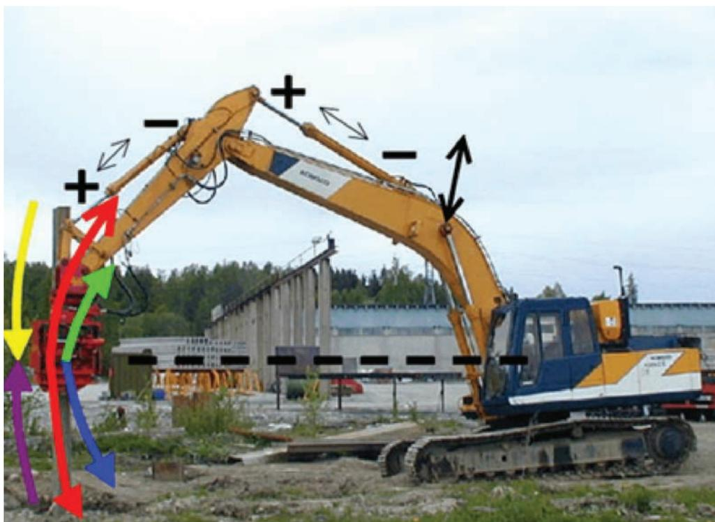
Рис. 6. Возможные траектории движения вибропогрузателя Impulse VP600R
